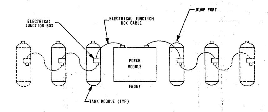
Figure 11. Tank Module Assembly Electrical Cable Conne tion
