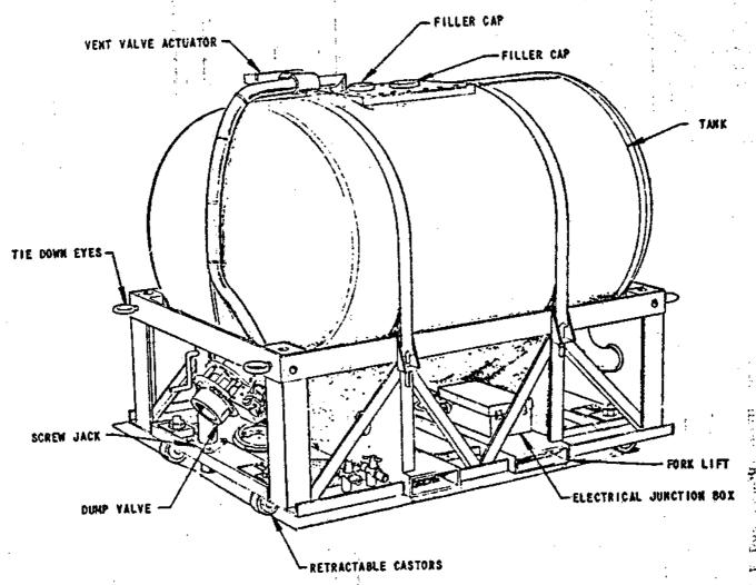
Figure 49. 500-Gallon Tank Module
