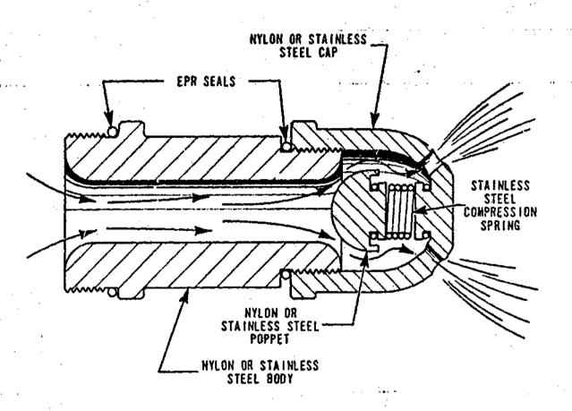
Figure 52. Check Valve-Type Nozzle
